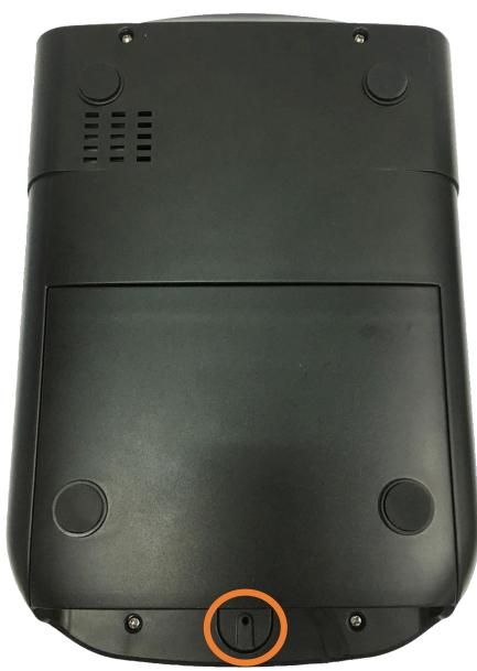
5. 盖起上盖后，将打印机翻转过来底部朝上，移除位于下盖的一颗螺丝，并将下盖打开。
