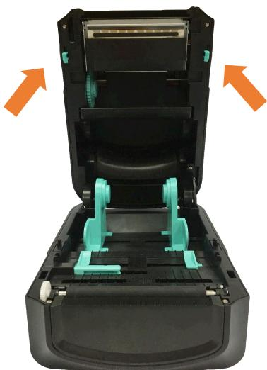
1. 双手向后推上盖释放钮以打开打印机上盖。
