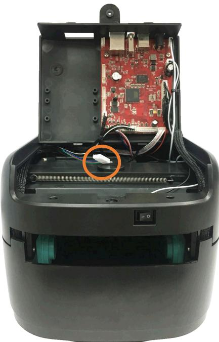
6. 打开后，将刚放进洞内的线拉出来，并插入主板上 10-pin 插槽。
