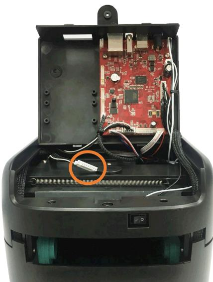
6. 打开后，将刚放进洞内的线拉出来，并插入主板上 10-pin 插槽。
