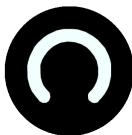
吐纸 / 暂停 / 错误取消按键 | 就绪状态时，按下此按键，机器会吐纸一张；在打印状态时，按下此按键，机器会立即停止；在错误状态时，按下此按键，机器会取消错误状态，恢复打印功能。 |
