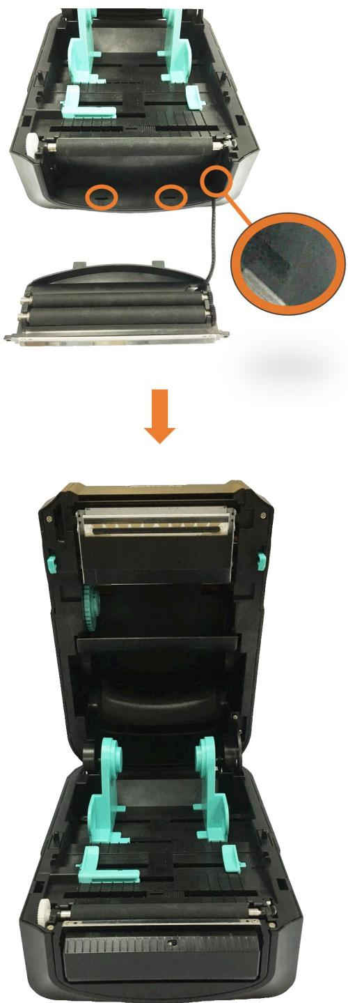
3. 将剥纸器的线放入洞内，并且将剥纸器对准卡榫。
